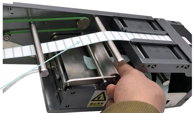
8.先手指压下此杆并扣好，待齿轴松开后，再如图从两齿轴之间穿插物料带（为防止夹手，建议使用工具（镊子）操作）。
